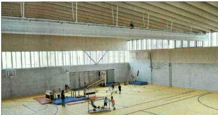
Die Doppelturnhalle in Auw: Das flache Satteldach wird durch eine dichte filigrane Holzrippenstruktur getragen Bild: wu
